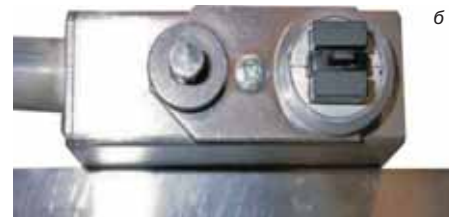
Рис. 1. Датчики МШБ производства Stresstech Oy, Финляндия для измерения: а – на боковой поверхности зуба шестерни; б – плоский датчик общего назначения
