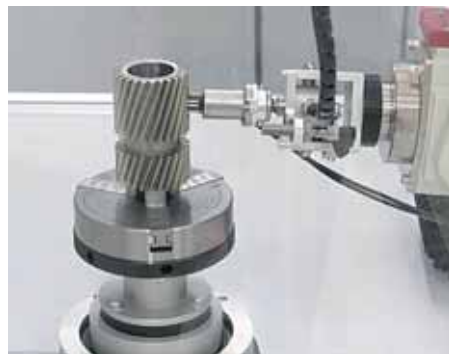
Рис. 7. Фотография процесса контроля винтового зубчатого колеса (фотография предоставлена Stresstech Oy, Finland)
