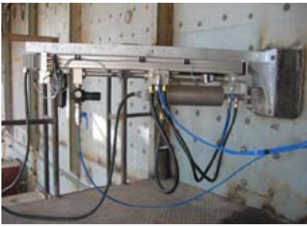
Рис. 2. Сенсоры, охлаждаемые воздухом и водой, с ретрактором
